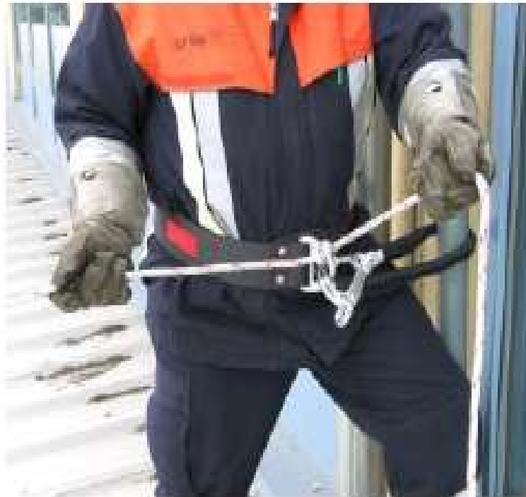
Führen der Feuerwehrleine mit Hilfe des Halbmastwurfs
