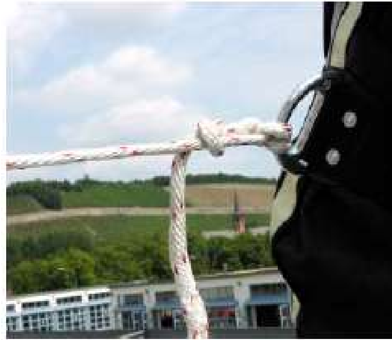
Beispiel: Mastwurf und Spierenstich am Feuerwehr-Haltegurt
