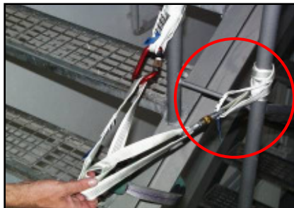
Festsetzen der Bandschlinge
